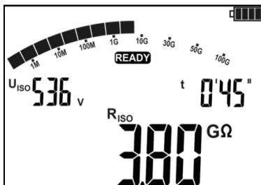
Al termine o all'interruzione della misurazione, leggere il risultato. Verranno visualizzati i risultati di tutte le misurazioni effettuate (anche se la misurazione viene interrotta, ad esempio, dopo 60 s). Se lo strumento è passato alla schermata di riposo, il risultato della misurazione può essere ripristinato con il pulsante **ENTER**.
